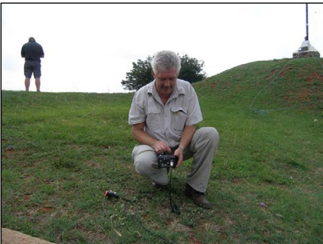
Fanie besig om die SWR van sy dipool te meet
